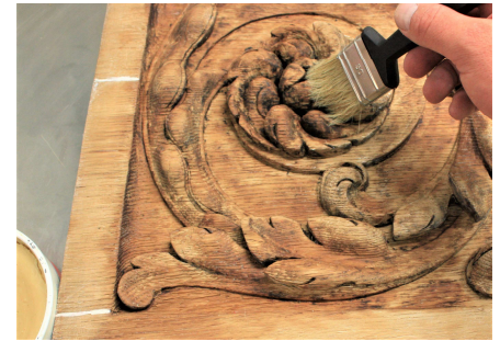
Fig. 3. Het ornament wordt voorzien van een losmiddel. Eerst met een doek en vervolgens met een kwast.
