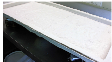
Fig. 10. De siliconenmal wordt in de steunkap teruggeplaatst en, in zijn geheel, waterpas opgesteld.
