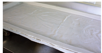
Fig. 12. Het glasvezel (triaxiaal) aangebracht op de gegoten acrylhars.
