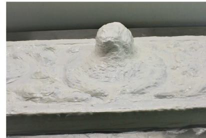
Fig. 6. De siliconen zijn aangebracht en gladgestreken. De mal is nu klaar om van een steunkap te worden voorzien.
