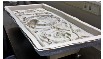
Fig. 10. De siliconenmal wordt in de steunkap teruggeplaatst en, in zijn geheel, waterpas opgesteld.
