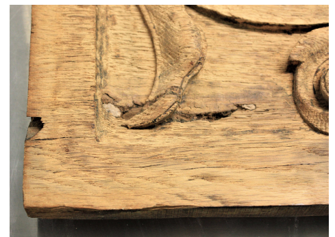
FIG.2. Een houtsnijwerk uit de 15 e eeuw. Boenwas is verwijderd en het hout is geschuurd. Wat overblijft is een zeer droog, gesplinterd en poreus oppervlak.
