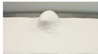
Fig. 8. De Acrylhars is +/- 5 mm dik aangebracht over het gehele siliconen model.
