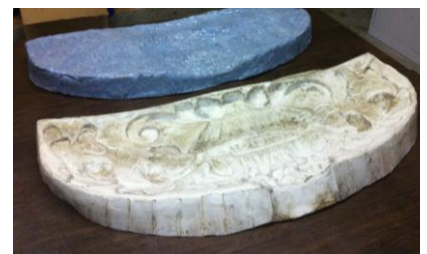
Fig. 12. De siliconen-mal met daarboven de epoxy steunkap.
