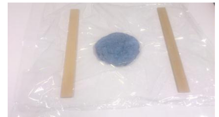
Fig. 7. De massa is goed gekneed en tussen twee lagen folie geplaatst. Links en rechts een latje van 3 mm dik.
