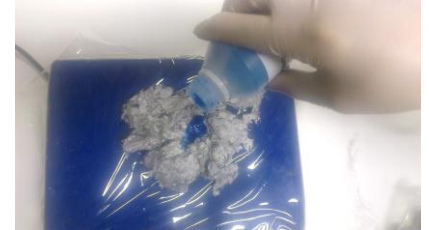
Fig. 5. 100 gram A component (vezel) wordt overgoten met 20 gram B component (vloeistof).
