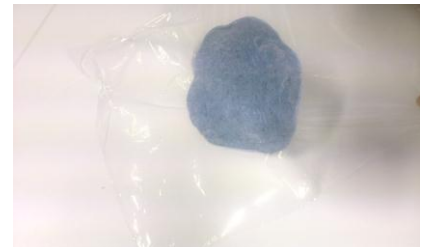
Fig. 10. De epoxy wordt met het onderste folie opgetild.
