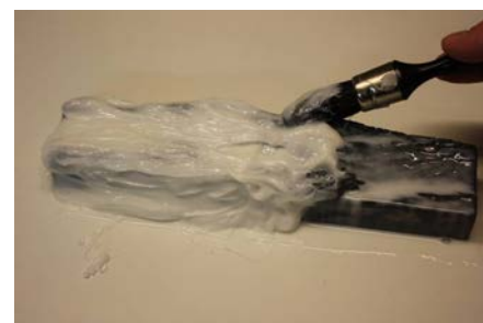
Fig. 4 : Met een penseel wordt de tweede laag siliconen aangebracht. Deze laag geeft de siliconenmal sterkte.
