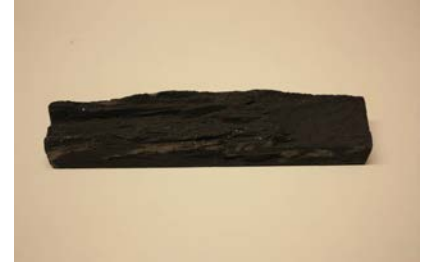
Fig. 1 : Een siersteen klaargemaakt om gekopieerd te worden. Oneffenheden zijn opgevuld en de steen is met een lossingspray behandeld.
