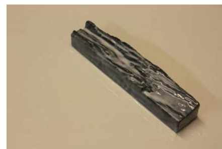
Fig. 3 : De siersteen is voorzien van een dunne laag siliconen. En wordt voor een korte tijd met rust gelaten.
