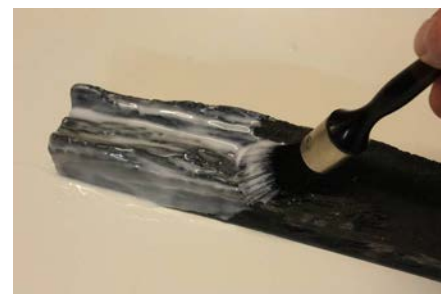
Fig. 2 : Met een penseel wordt de eerste laag siliconen aangebracht. Eventuele luchtballen worden
