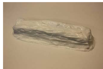
Fig. 5 : De siersteen is compleet voorzien van een laag siliconen met een dikte van +/- 5 mm.
