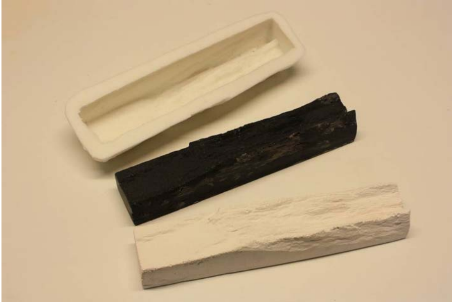
Fig. 5 : Het origineel de mal en een in Acrystal afgevormd kopie.
