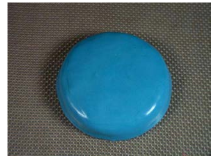
Fig. 9. Het gehele model is bedekt en wordt een uur met rust gelaten om uit te harden.
