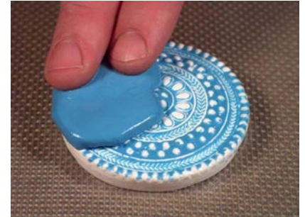
Fig. 8. Een tweede laag ( \pm 5\text{ mm} dik) wordt over de eerste laag aangebracht.
