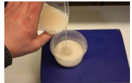
Fig. 4 : Als de A en B component goed met de vulstof zijn gemengd gaan ze bij elkaar en word er weer goed gemengd.
