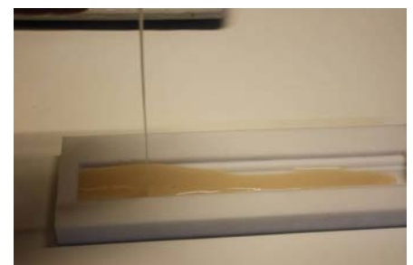
Fig. 5 : Giet met een dunne straal en laat de PU vooruit lopen.
