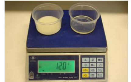
Fig. 2 : Twee Mengbakken, 60 gram A-comp en 60 gram B-comp (1 : 1)
