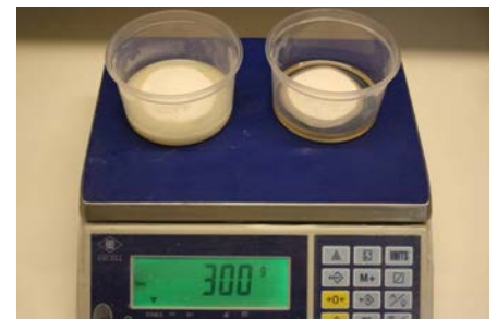
Fig. 3 : 180 gram vulstof (300 %) over de A en B component verdeeld. 300 gram totaal mengsel (1 : 1 : 3).
