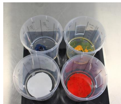
Fig. 3 : Vier mengbakjes met elk 20 gram A-component en 10 gram B-component. Daaraan toegevoegd een zeer kleine hoeveelheid kleurstof.
