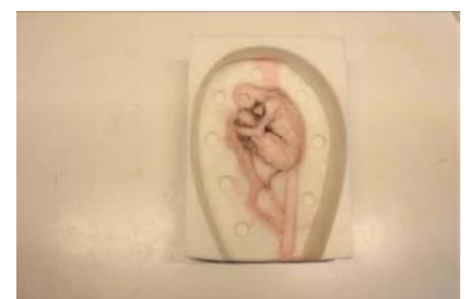
Fig. 12: Nadat het model verwijderd is klapt de mal terug in oorspronkelijke vorm en zijn de sneden praktisch onzichtbaar.
