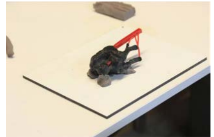
Fig. 2: Het model wordt gepositioneerd en voorzien van gietkanalen.
