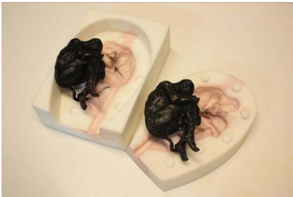
Fig. 13: Het moedermodel de mal en het (boetseerwas) afgegoten kopie.
