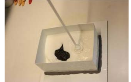
Fig. 9: Rondom de gevormde deelmal wordt een omkisting geplaatst. De omkisting wordt zorgvuldig afgedicht.
