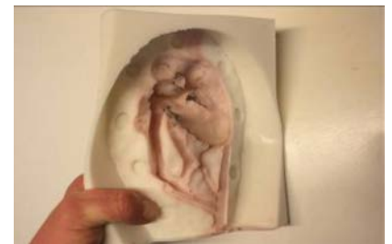
Fig. 11: Het model inclusief de kanalen kan gemakkelijk uit de mal worden verwijderd.
