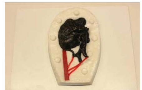
Fig. 7: Het model is tot de helft (deelnaad) voorzien van een siliconen mal. De siliconen zijn ingesmeerd met Vaselinezalf.
