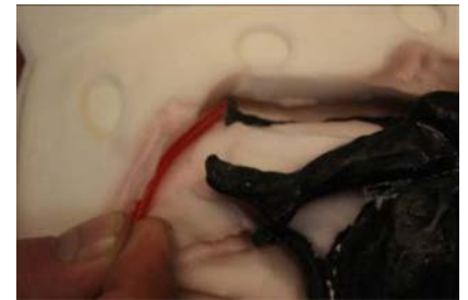
Fig. 10: De ontluchtkanalen worden vrij gesneden.
