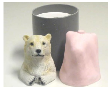
Fig. 11: Na 4 uur kunt u de siliconen ontmallen.
