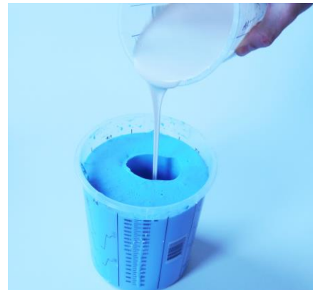
Fig 4.: De Acrylic One wordt met een dunne straal gegoten.
