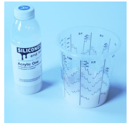
Fig 2.: 300 gram A component (vloeistof)
