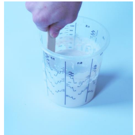
Fig 3.: 600 gram B component (poeder) wordt aan de vloeistof toegevoegd en de componenten worden goed door elkaar gemengd.
