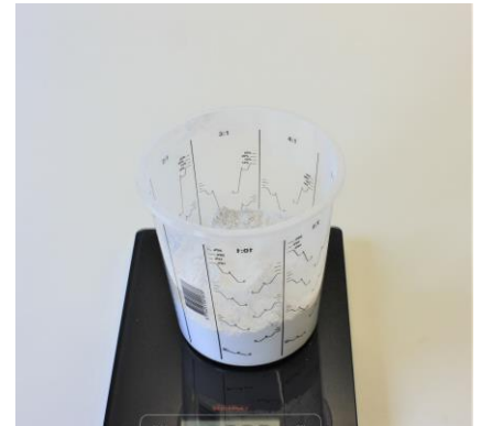
Fig. 2: 350 gram poeder wordt in een maatbeker gedaan.
