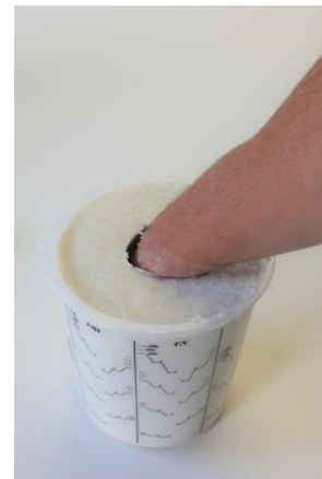
Fig. 6: zorg tijdens het ontmallen dat er lucht in de mal komt en de mal niet inscheurt
