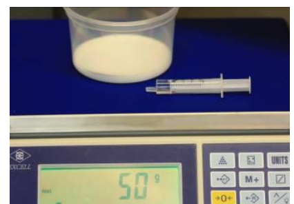
Fig. 3: Omdat de B-component vaak in kleinere hoeveelheid wordt toegevoegd is het handig om gebruik te maken van een doseerspuit. Hierbij kunt u 1 ml. nemen als 1 gr.
