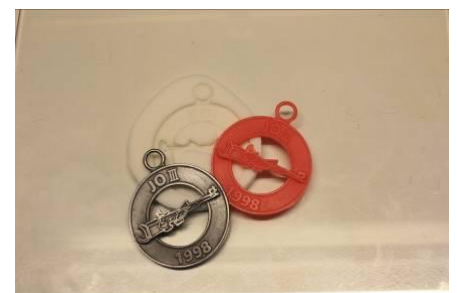
Fig. 5: Het moedermodel, de mal en een in gietwas afgevoerd model (rood)
