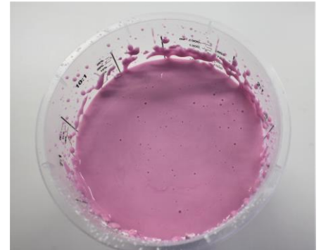
Fig. 3: 1400 ml. water gemengd met 470 gram alginaat 3D-gel.
