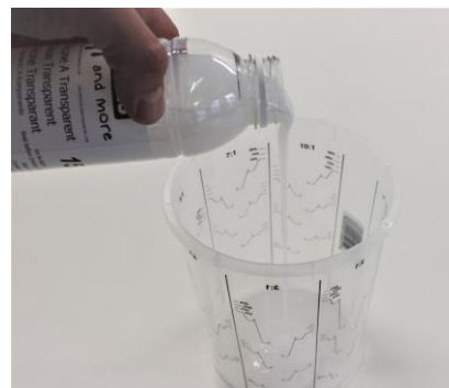
Fig. 1. Giet 500 gram siliconen A-component in de 1100 ml . maatbeker.
