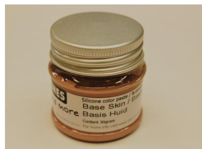
Fig. 2. We voegen 0,5 % kleurstof toe aan de A component. (0,5 % van 500 gram is 2,5 gram)
