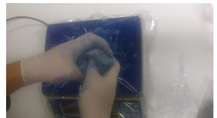
Fig. 3 : Kneed de componenten tot een homogene massa. Gebruik van handschoenen wordt aangeraden!
