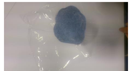
Fig. 6 : Het bovenste folie is verwijderd en de epoxy wordt aan de onderste laag folie opgetild.
