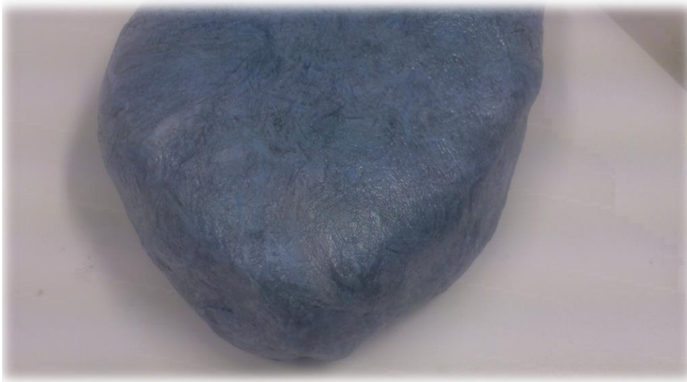
Fig. 9 : Het moedermodel voorzien van siliconen en een steunkap van epoxy.
