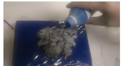
Fig. 2 : B component (16 gram) wordt over de A component gegoten.
