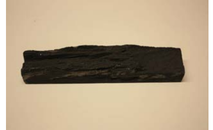
Abb. 1 : Ein Schmuckstein soll kopiert werden. Unebenheiten wurden aufgefüllt, und der Stein wurde mit einem Gleitspray behandelt.
