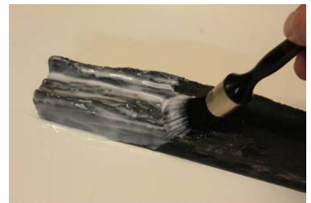
Abb. 2 : Mit einem Pinsel wird die erste Schicht Silikon aufgetragen. Eventuelle Luftblasen werden beseitigt.
