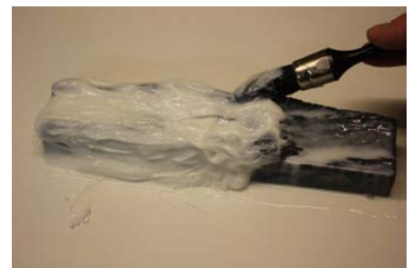
Abb. 4 : Mit einem Pinsel wird die zweite Schicht Silikon aufgetragen. Diese Schicht verleiht der Silikonform Festigkeit.
