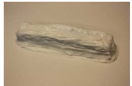
Abb. 5 : Der Schmuckstein ist vollständig mit einer ca. 5 mm dicken Schicht Silikon bedeckt.
