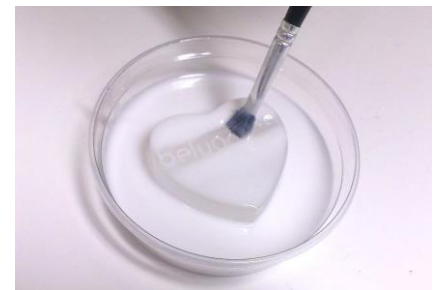
Fig. 4.b. : Details kann man am besten nachpinseln damit Luftblasen entfernt werden.
