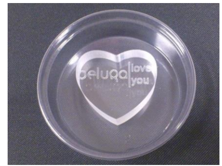
Fig. 3 : Muttermodell, fixiert mit Klebstoff in einem Plastikbecher
