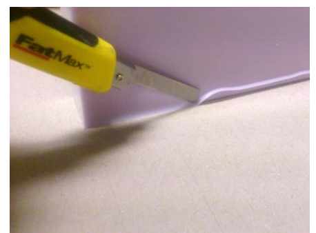
Fig. 12 : Mit einem scharfen Messer werden Fransen weggeschnitten.
