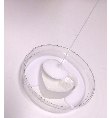
Fig. 4 : Mit einem dünnen Strahl wird das Modell luftbläschenfrei bis auf das gewünschten Niveau abgegossen.
