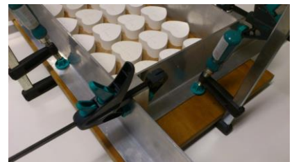
Fig. 9 : Die Ränder werden nicht nur aneinander , sondern auch an dem Untergrund gut mit Schraubzwingen befestigt.
