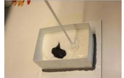
Abb. 9: Rund um die Teilform wird eine Verschalung angebracht und sorgfältig abgedichtet.
