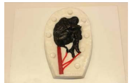
Abb. 7: Das Modell ist bis zur Hälfte (Teillinie) mit einer Silikonform versehen. Das Silikon wurde mit Vaseline behandelt.
