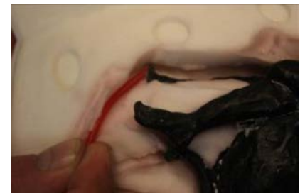
Abb. 10: Die Entlüftungskanäle werden frei geschnitten.
