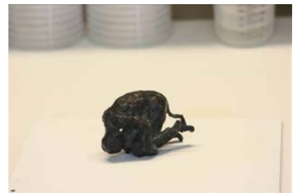
Abb. 1: Das Urmodell (Bronze) ist sauber. Ein Gleitmittel ist in diesem Fall nicht erforderlich.
