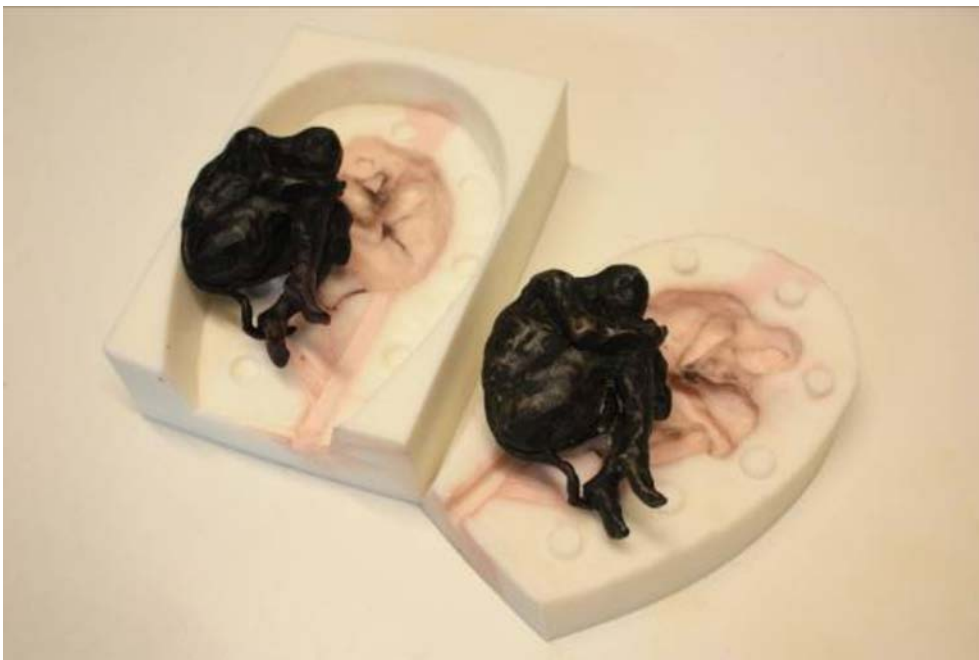
Abb. 13: Das Urmodell, die Form und die (in Modellierwachs) gegossene Kopie.
