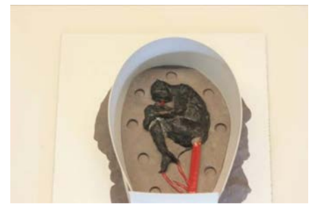
Abb. 5: Ein eingebettetes Modell mit Verschalung, bereit für den Guss.
