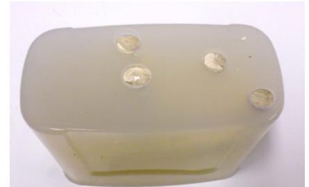
Fig. 5: De vier poten van de olifant die dienen als gietopening en ontluchtkanaal.
