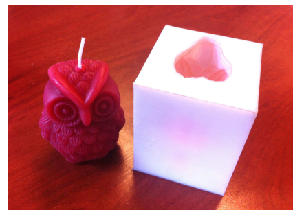
Fig. 6 Afspoelen met water en zeep, de mal is klaar voor gebruik.
