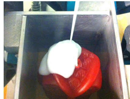
Fig. 5 Giet de siliconen met een dunne straal en vanuit één punt.
