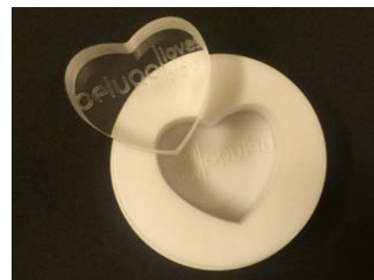
Fig. 5 : Het moedermodel boven op de moedermal van siliconen.
