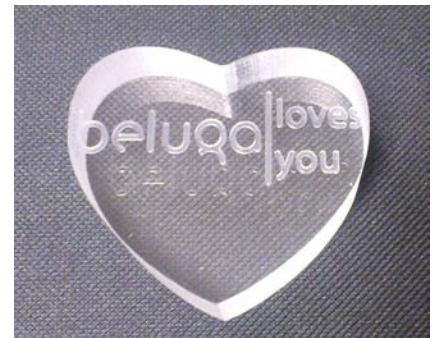
Fig. 2 : Moedermodel, uit plexiglas gefreesd (uitbesteed).
