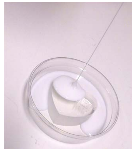
Fig. 4 : Met een dunne straal wordt het model tot het gewenste niveau en luchtbelvrij afgegoten.
