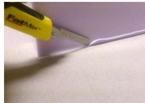
Fig. 11 : De mal wordt voorzien van een paars/roze bovenlaag.
