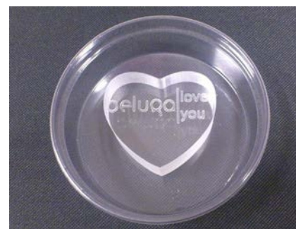
Fig. 3 : Moedermal, vastgezet met lijm in een plastic bakje.
