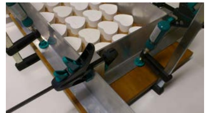
Fig. 9 : De border wordt niet alleen goed aan elkaar geklemd maar vervolgens ook met stevige lijmklemmen op de plank gezet.
