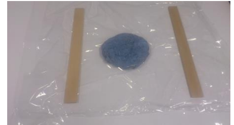
Fig. 4 : De kneedmassa tussen twee lagen folie. Links en rechts een latje van 3 mm dik.
