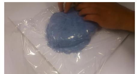
Fig. 7 : De epoxy wordt over het siliconen model geplaatst en aangeduwd.
