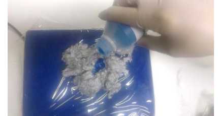
Fig. 5. 100 Gramm A Komponente (Fasern) wird mit 20 Gramm B Komponente (Flüssigkeit) übergossen.
