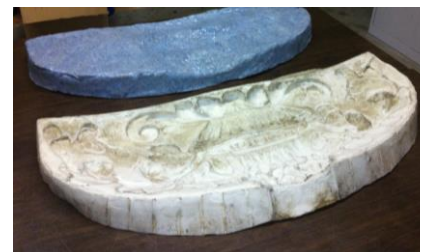
Fig. 12. Die Silikonform und darüber die Epoxid Stützform.
