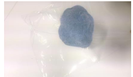
Fig. 10. Das Epoxid wird mit Hilfe der unteren Folie angehoben
