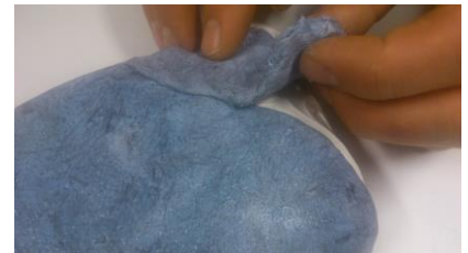
Fig. 11. Lassen Sie Epoxid-Teile immer 1cm überlappen und massieren sie die Nähte gut zusammen.
