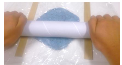
Fig. 8. Mit einer Rolle wird die Masse auf 3mm ausgerollt.
