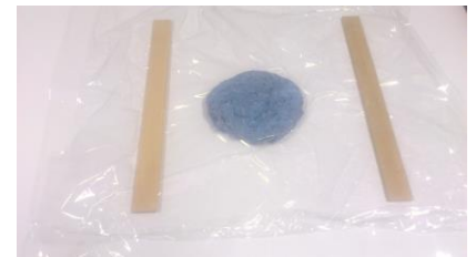
Fig. 7. Die Masse ist homogen und liegt zwischen zwei Lagen Folie. Links und rechts befinden sich zwei 3mm dicke Leisten.
