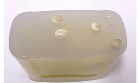
**Fig. 5:** Die vier Beine des Elefanten dienen als Gießöffnung und Entlüftungskanal.
