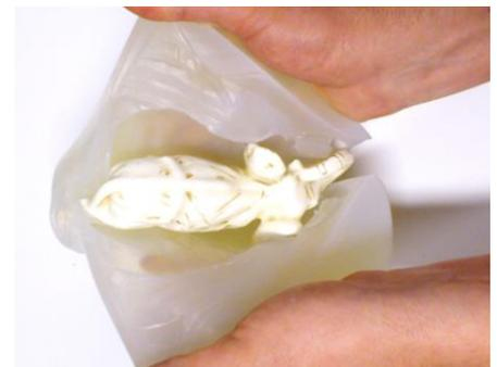
**Fig. 4:** Die Form ist an der Oberseite (entlang des Rückgrats) des Elefanten aufgeschnitten worden, sodass das Modell herausgenommen werden kann.
