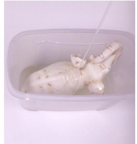
**Fig. 3:** Das Silikon wird in einem dünnen Strahl bis zu einer Höhe von +/- 4cm gegossen. Nach 3 Stunden wird der Rest der Form gegossen, um sicher zu gehen, dass das (hohle) Modell nicht treibt.
