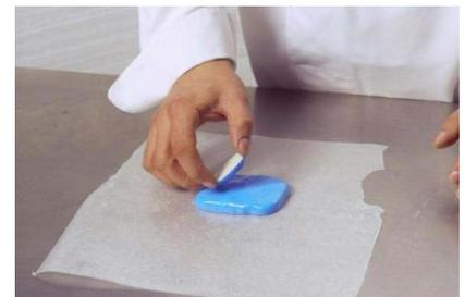
**Fig. 3.** Das Modell, versehen mit einer dünnen Schicht Plastique, wird in das restliche Silikon gedrückt.
