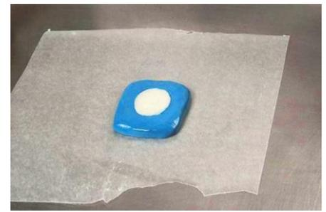
**Fig. 4.** Lassen Sie das Ganze für +/- 1 Stunde ruhen bis es vollständig ausgehärtet ist.
