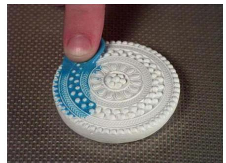
**Fig. 7.** Eine dünne erste Schicht wird in die Details gedrückt.
