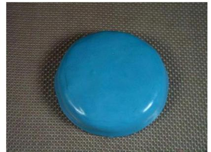
**Fig. 9.** Das gesamte Modell ist bedeckt und wird für die Aushärtung eine Stunde ruhen gelassen.
