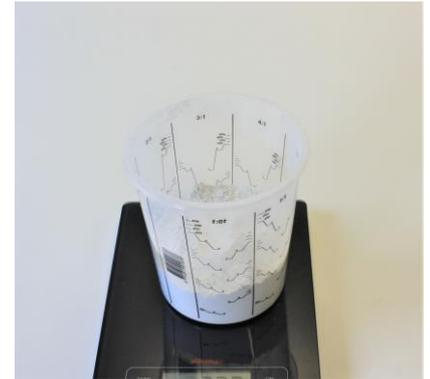
**Abb. 2:** Ein Messbecher, gefüllt mit 360 g 3-D Gel. Wasser wird im entsprechenden Verhältnis der Gewichtsanteile zugegeben. 1 Teil Pulver : 4 Teilen Wasser.
