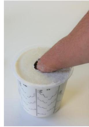
**Abb. 5:** Das Gel ist ausgehärtet, die Hand kann heraus gezogen werden. Achten Sie beim Entformen darauf, dass Luft in die Form gelangt und die Form nicht einreißt.
