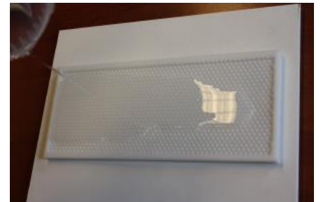
Abb. 5: Gießen Sie mit einem dünnen Strahl, und lassen Sie das PU voraus laufen.
