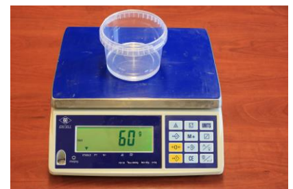
Abb. 3 : Mischbehälter, 30 Gramm A-Komponente mit 30 Gramm B-Komponente (1 : 1).
